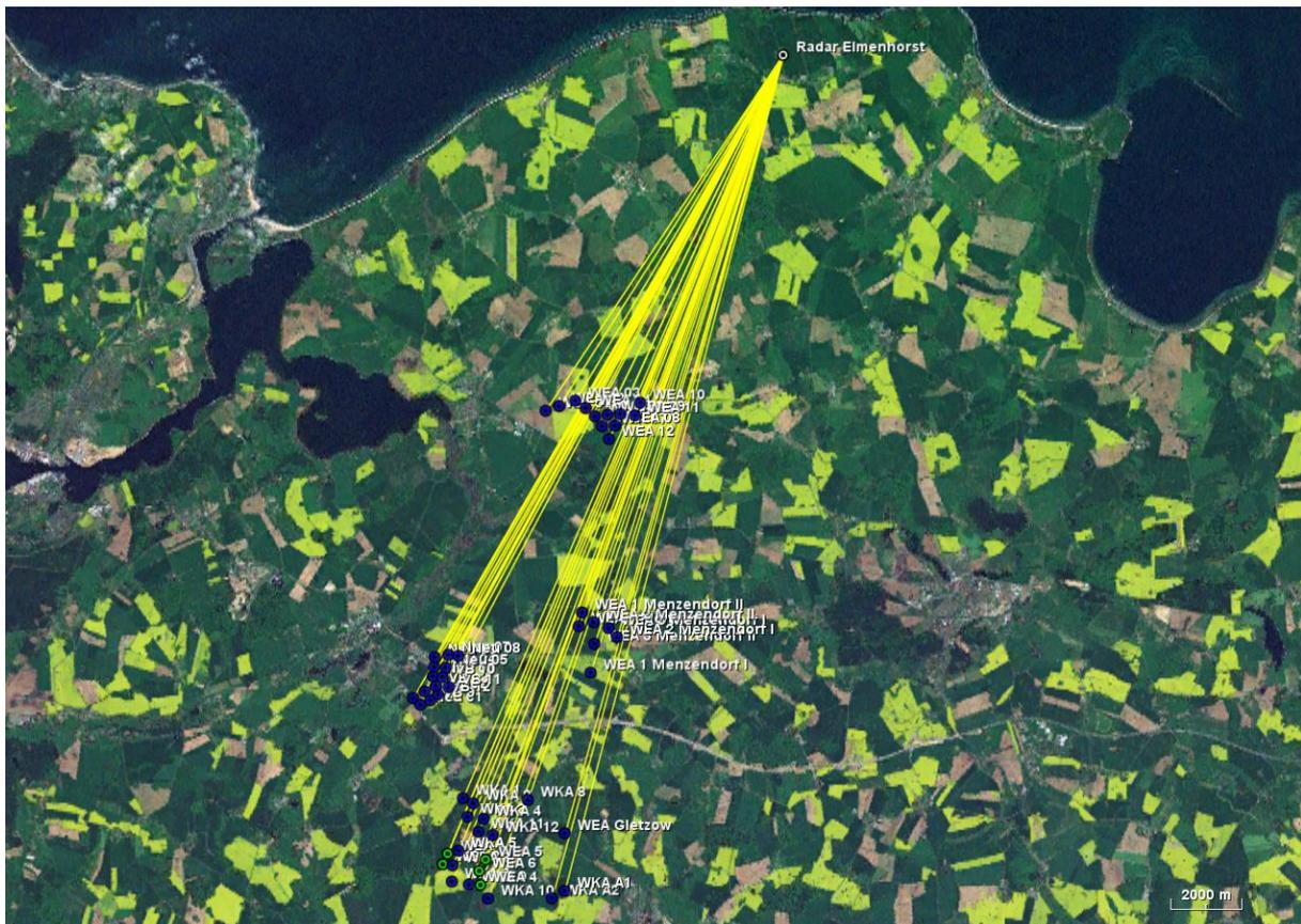
Abbildung 3: Luftaufnahme des Windparks Löwitz-Torisdorf mit den geplanten Windenergieanlagen (grün), sowie der relevanten Vorbelastung (blau). Die Einstrahlungsrichtungen bzgl. der Radaranlage Elmenhorst sind gelb dargestellt. Um eine bessere Übersicht zu gewährleisten wurden die Bezeichnungen von einzelnen Anlagen teilweise ausgeblendet.
