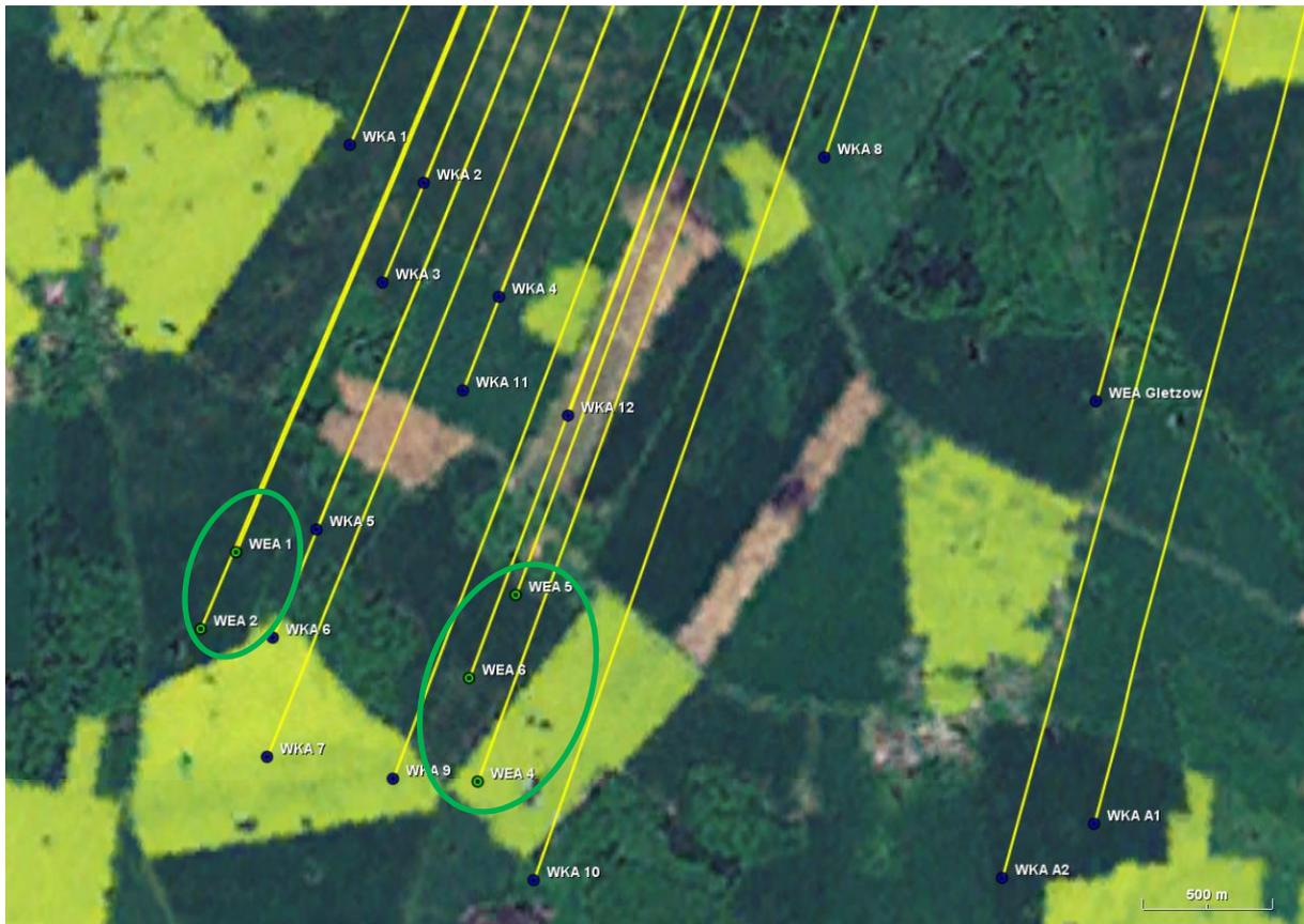
Abbildung 12: Übersicht über den Windpark Löwitz-Torisdorf mit den geplanten Windenergieanlagen (grün), sowie der Vorbelastung (blau). Die Einstrahlungsrichtungen bzgl. der Radaranlage Elmenhorst sind gelb dargestellt.
