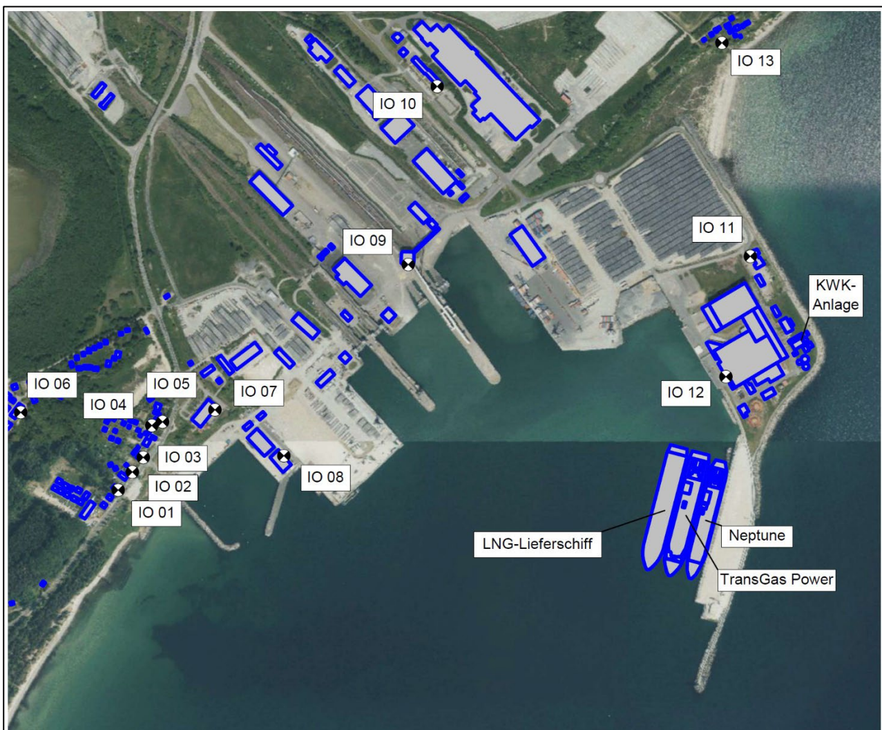
Abbildung 8: Übersichtsplan mit Kennzeichnung der Anlagenteile und Immissionsorte.
