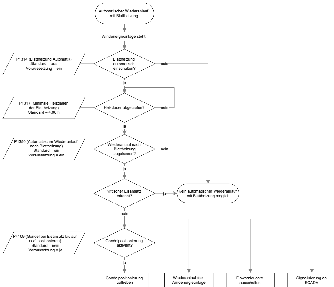
Abb. 3: Automatischer Wiederanlauf mit Blattheizung
