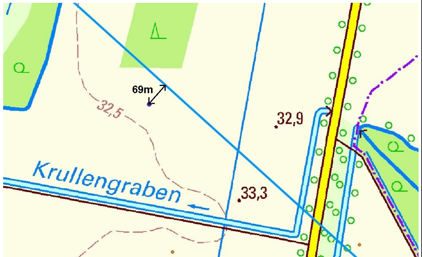
Abbildung 21: Funklinie Bandenitz – Groß Laasch (hellblau) im funkkritischen Bereich des zu errichtenden Windparks (violett)
