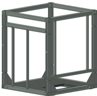
Abb. 3: Stahlrahmen mit Balken und Stützen in der ersten Ebene des EP3-EM-5E
