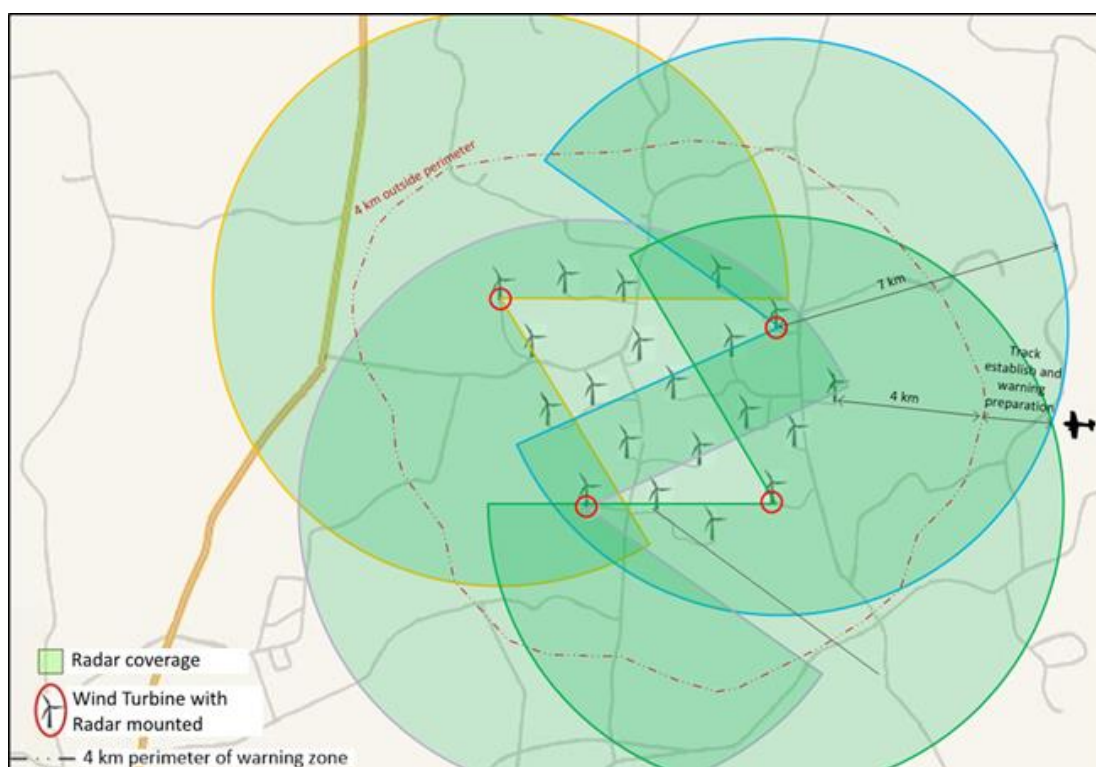
Abbildung 6-1: Abdeckung des Gebiets um die äußere Grenze der Windenergieanlage, wo die Radargeräte auf WEA angebracht sind, durch das Vestas IntelliLight-Radar, im Beispiel gemäß der deutschen Vorschrift mit einer Warndistanz von 4 km.
