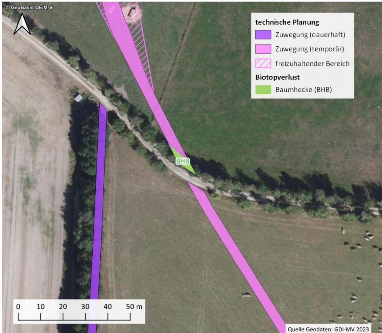
**Abbildung 36: Baumentnahme in Bereich der Baumhecke der temporären Zuwegung WEA 5**
