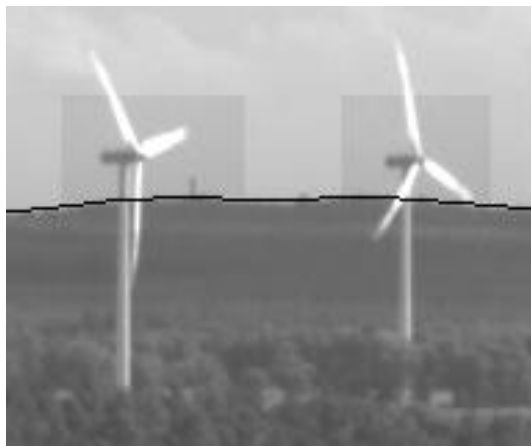
Abbildung 1: Automatisch generierte Ausschlussgebiete um Rotoren von WEA
