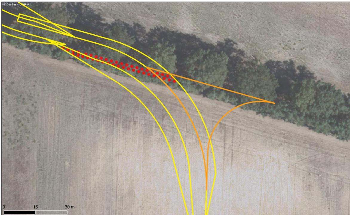
Abbildung 16: bauzeitlicher Gehölzverlust (rote Punkte) im Bereich der temporären Zuwegung (orange) zur WEA 06
