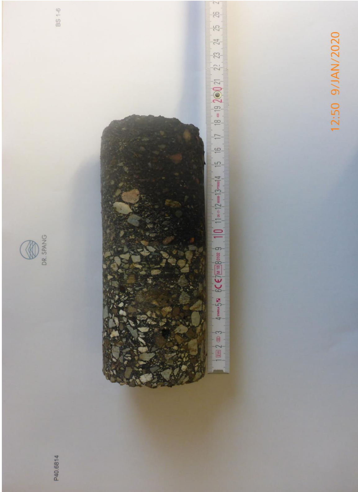
Bild Nr. 2: Asphaltkern BS 1-6
