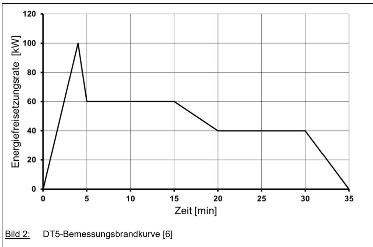
Bild 2: DT5-Bemessungsbrandkurve [6]
