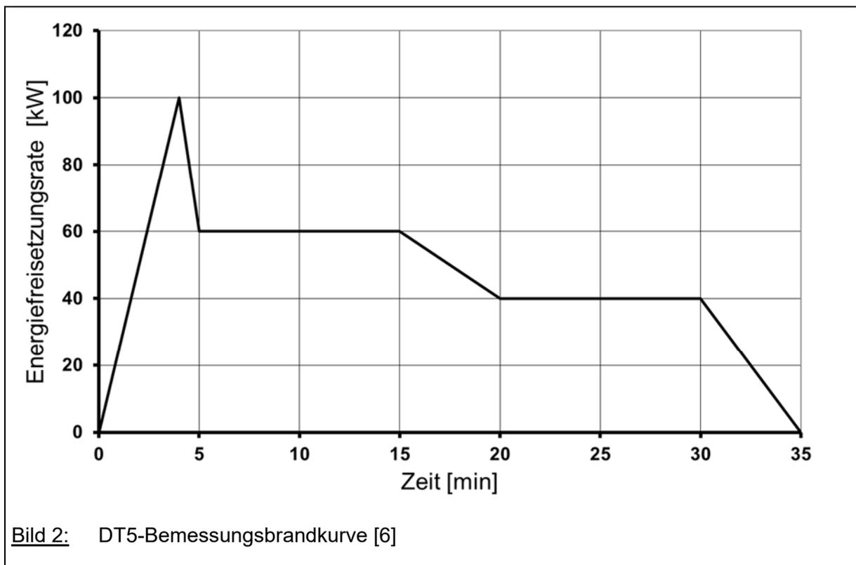
Bild 2: DT5-Bemessungsbrandkurve [6]
