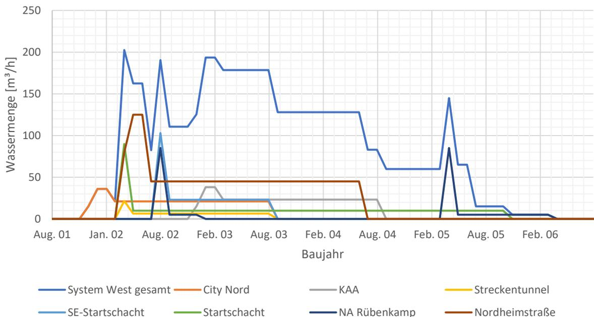
**Abbildung 2:** Maximaler Wasseranfall aus Leckagewasser, Lenzvorgängen und Aufbereitung der Bentonitsuspension in jedem Monat
