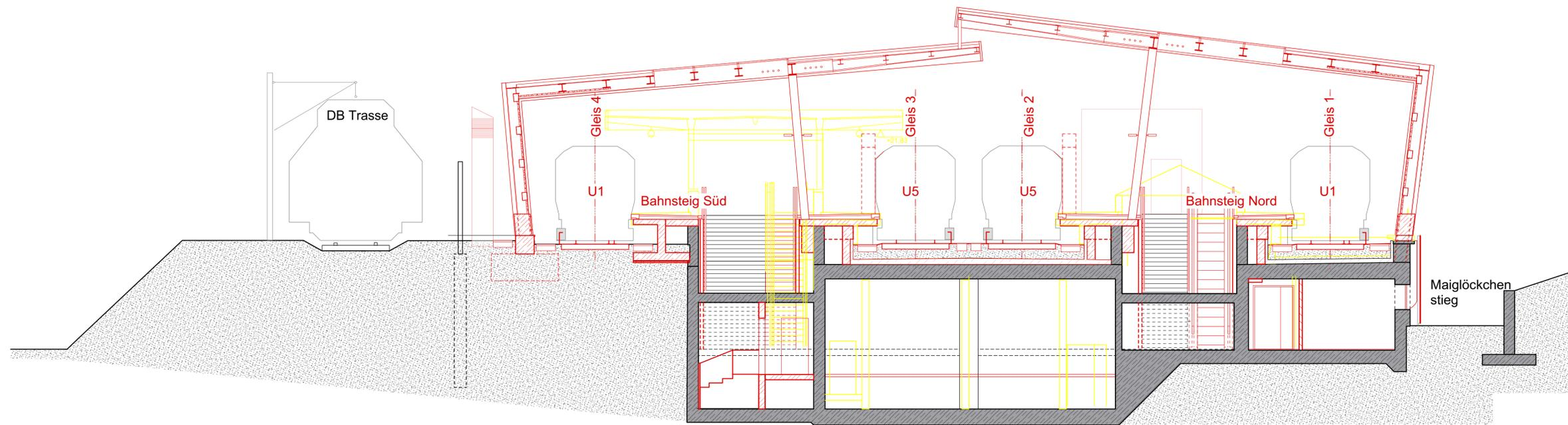
Schnitt D-D durch Treppenaufgänge und Technikkeller
