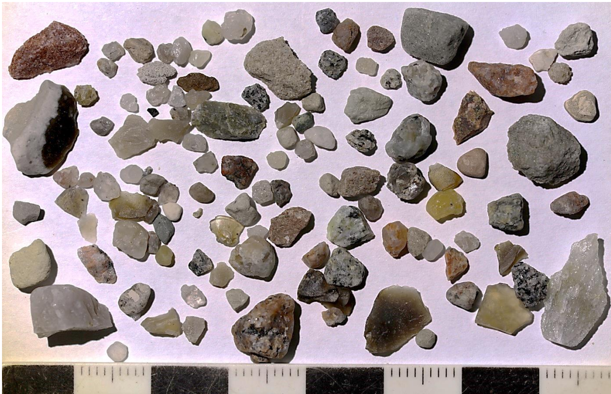
Abb. 1: Gesamtmenge Partikel der Fraktion > 2 mm von Probe B 20/17, GP 19 (Mittelsand). Bei 18 von 107 Partikeln handelt es sich um scharfkantige Flinte (17 % Gesamt-Anteil)
