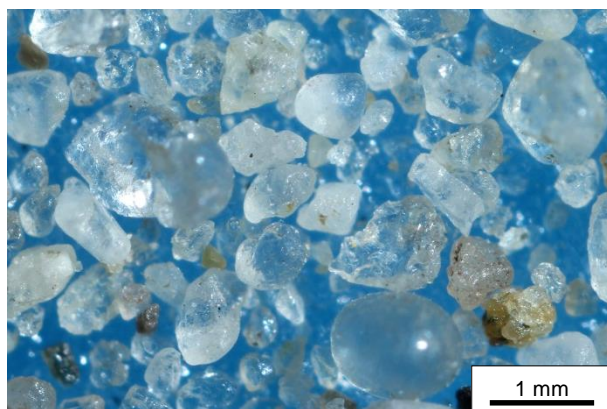
Probe B 35-12 (L 606-7-17): Mikroskopaufnahmen der Gesamtfraktion mit beispielhaft ausgewählten Einzelkörnern zur Darstellung von Kornform sowie Rundungsgrad (s. u.)
