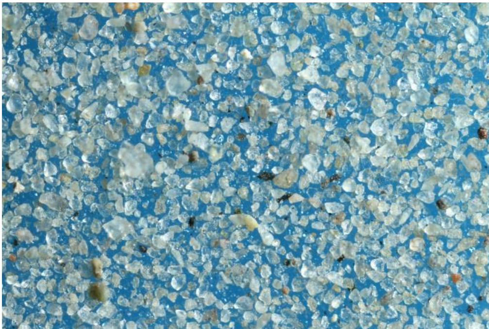
Bild 1: Probe B40-8 (L 606-8-17), Feinsand, mittelsandig aus P5 aus 10,5 m Tiefe mit hoher Kugeligkeit und überwiegend gerundeten Quarzen und Quarziten
