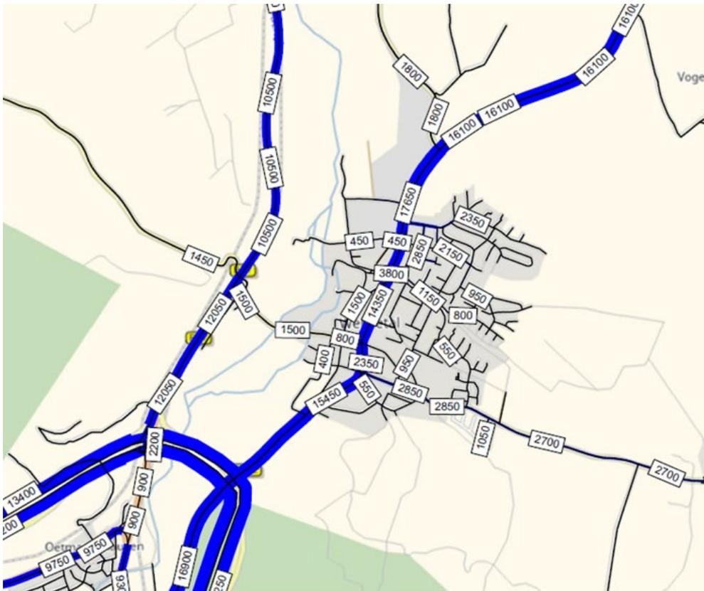
Bild 4: Prognose-Null-Fall 2035 (Kfz/Tag)<sup>3</sup>
