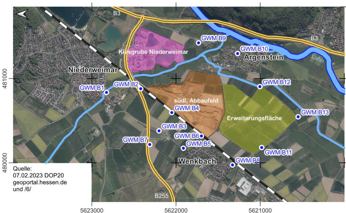
Abbildung 6: Lage der Grundwassermessstellen um den Tagebau Niederweimar
