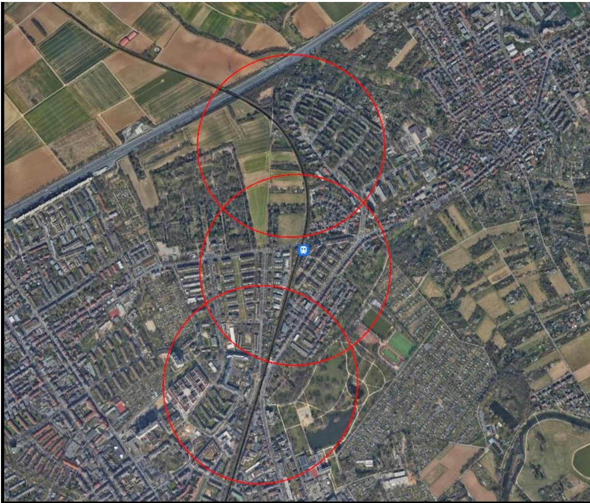
Abbildung 6: Einzugsgebiete Verkehrsstationen im 400 m-Radius, Quelle: RTW, Anlage 3 zum Wortprotokoll des Erörterungstermins am 19.10.2023
