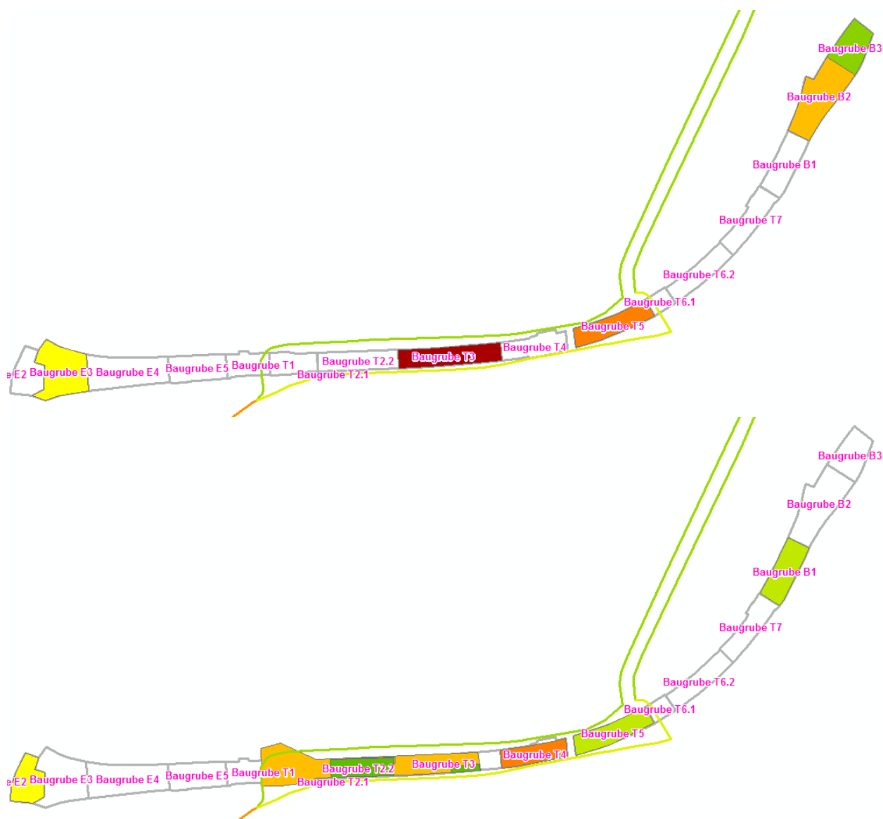
Abbildung 5-4: Verteilung der PM10-Emissionen auf den Baufeldern in relativer Darstellung (rot = hoch über gelb bis grün = gering) für Episode C (oben) und Episode D (unten)
