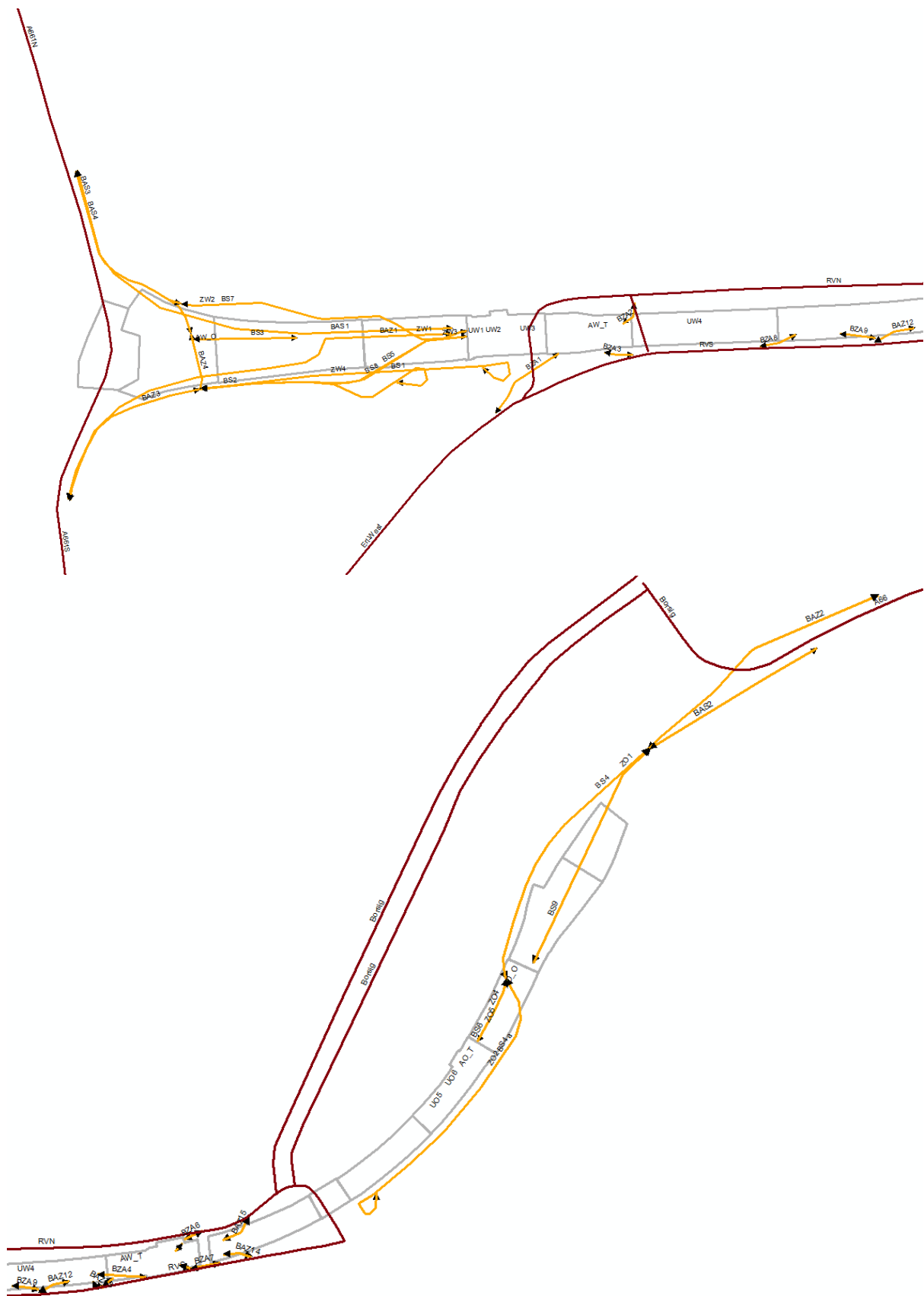
Abbildung 4-2: Baustraßen (orange), öffentliche Straßen (rot) und Baufelder im westlichen (oben) bzw. im östlichen (unten) Baustellenbereich; Detailvergrößerung aus Abbildung 4-1
