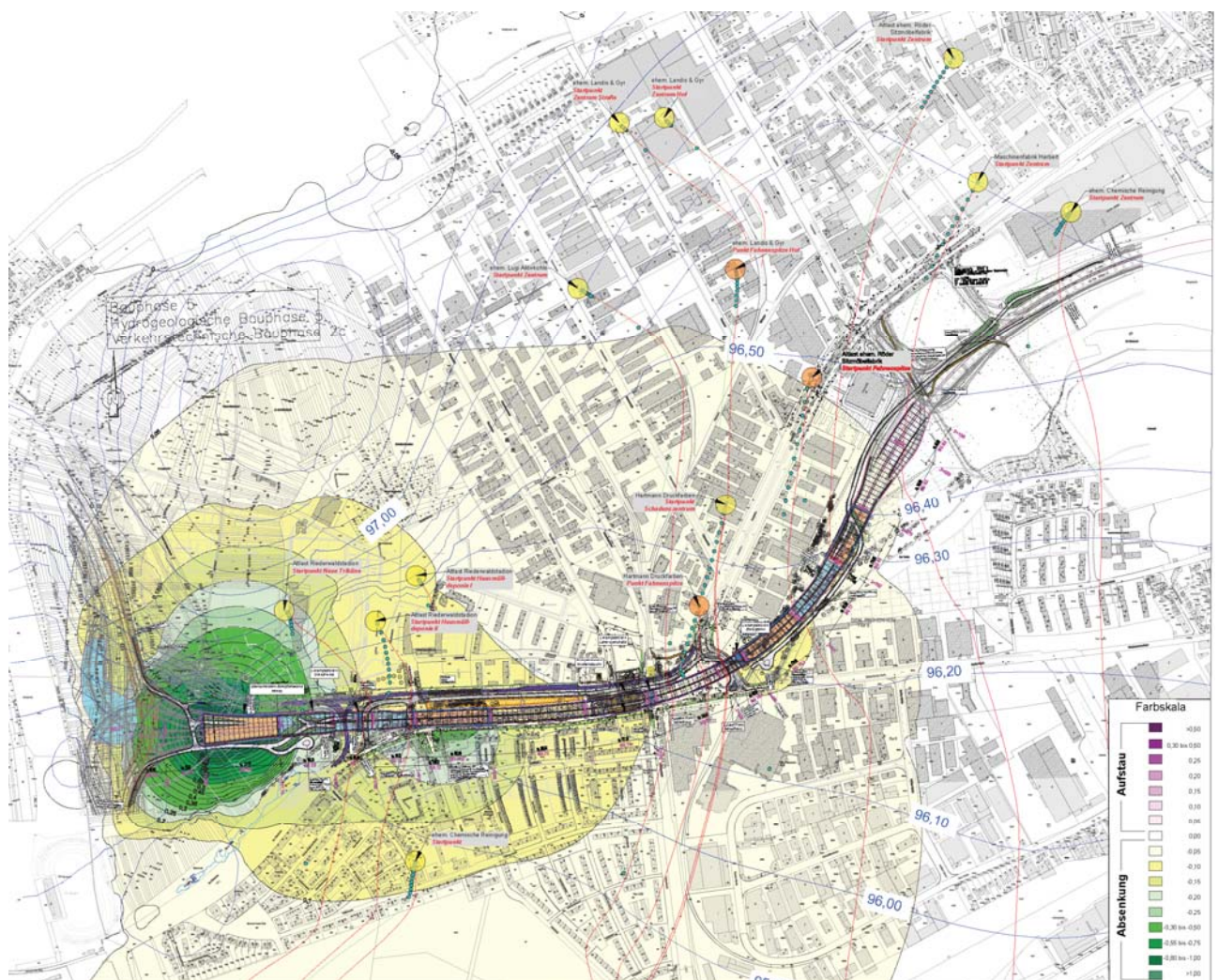
Abbildung 23: Hydrogeologische Bauphase 5, Gesamtansicht, GW-Gleichen, Differenzenplan, Strömungslinien
