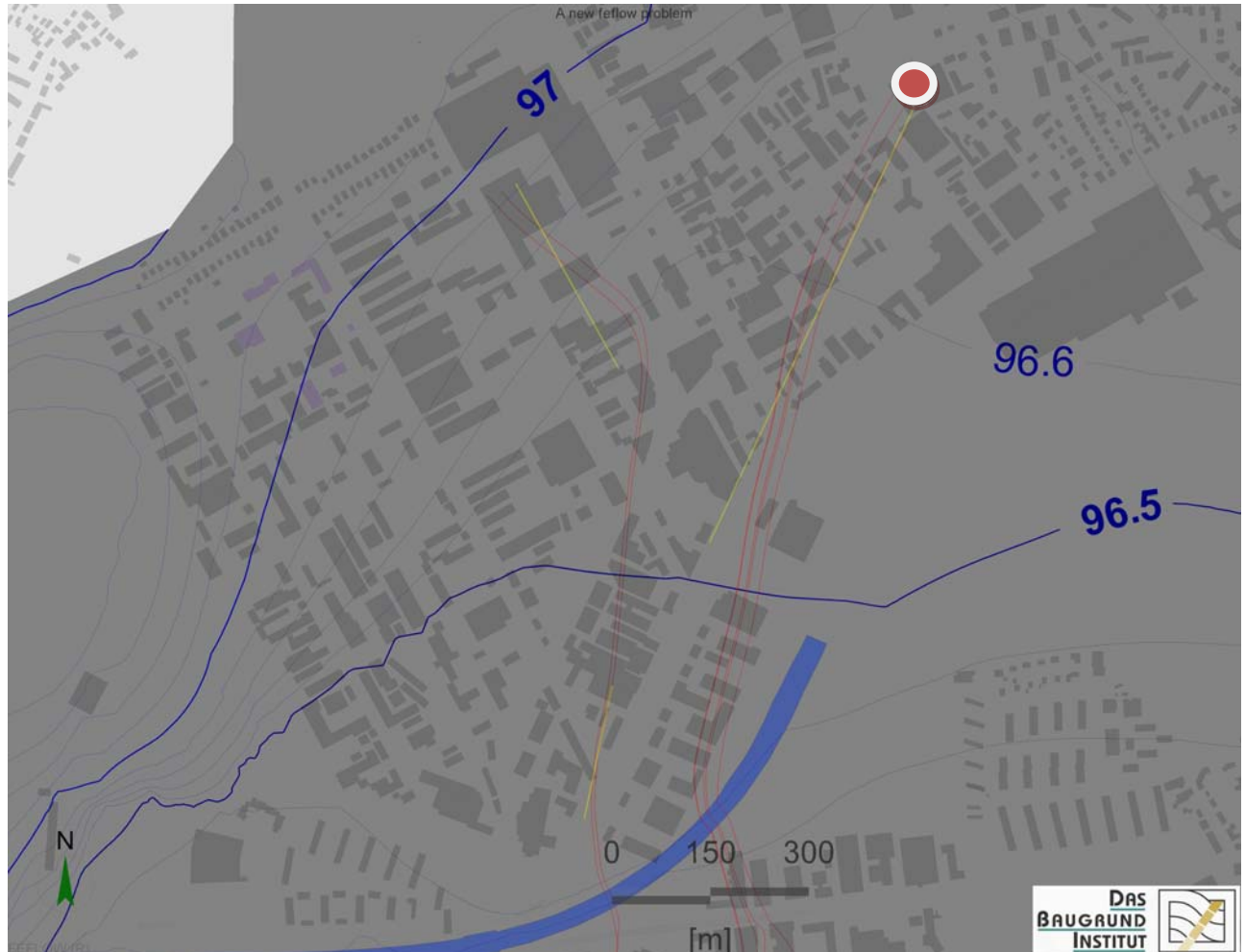
Abbildung 6: Darstellung der Grundwassergleichen im Nordbereich, Darstellung der Fahnenachsen (gelbe Linien) und Darstellung der Strömungsbahnen (rote Linien)
