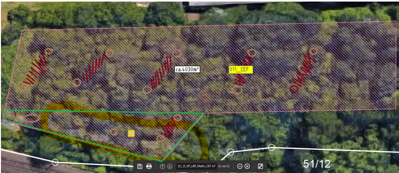
Abbildung 13: Herrichtung des Lebensraums vor Baubeginn. Rodungsbereiche (grün), Auslage von Schnittgut (braun) und Anlage von Erdaufschlüssen (ocker).
