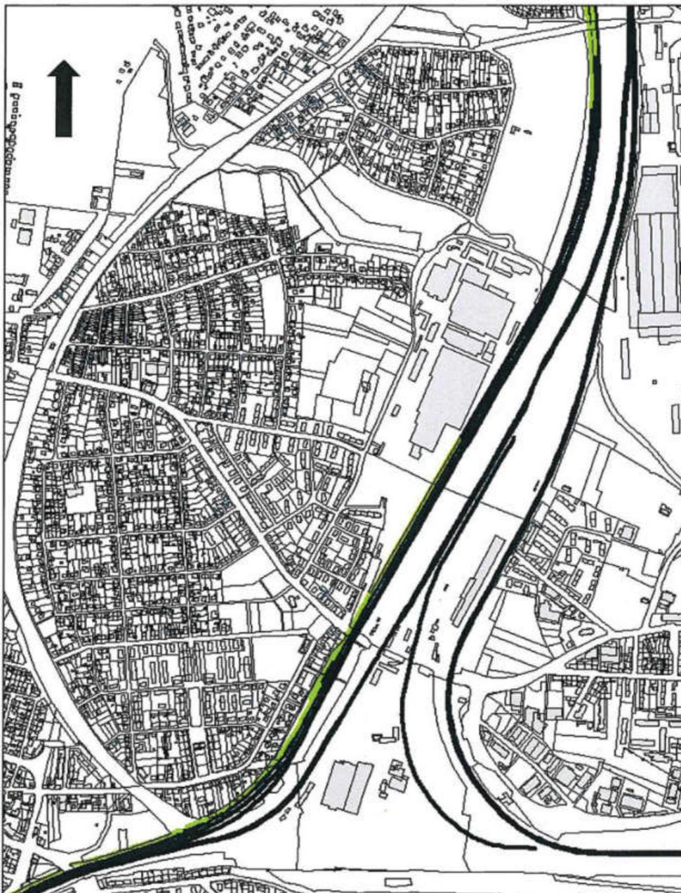
Abbildung 7: Überblick über die berücksichtigten Emissionsquellen für die Betrachtung der Lärmvorbelastung; Schienenverkehr (schwarz); Schallschutzwände (grün).
