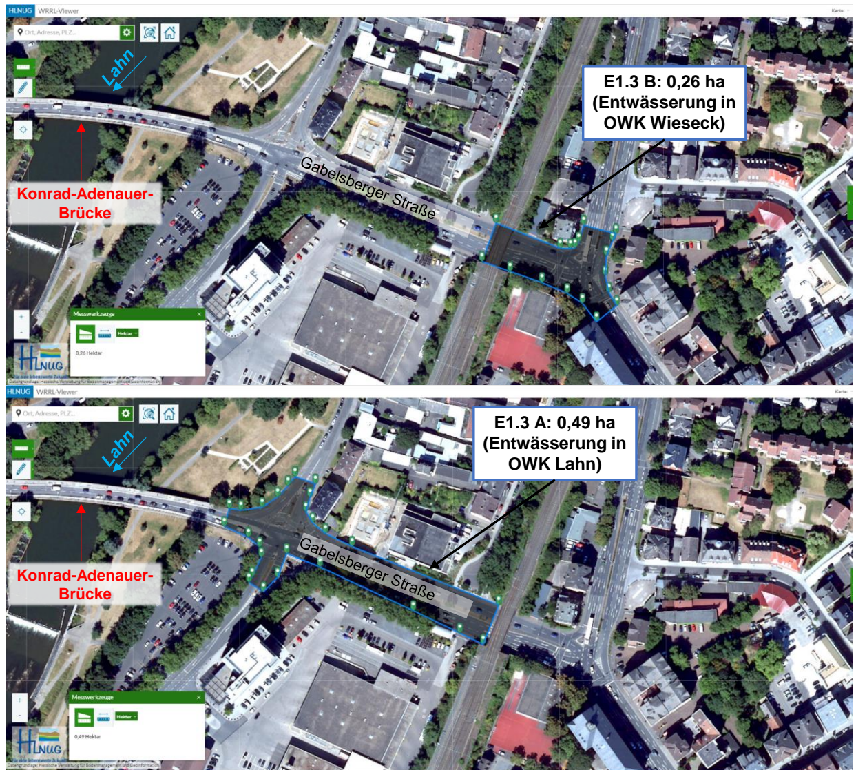
Abbildung 6-1: Entwässerungsabschnitt 3.1A und B in /I/ mit Abtragung der Fahrbahnfläche
