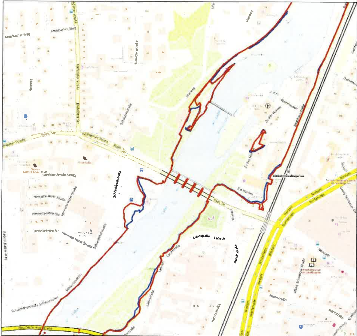
Abbildung 5: Überflutungsflächen HQ100 im Bereich Adenauer-Brücke / Brücke Rodheimer Straße - Bauphase I (rot) und Istzustand (blau) [1]
