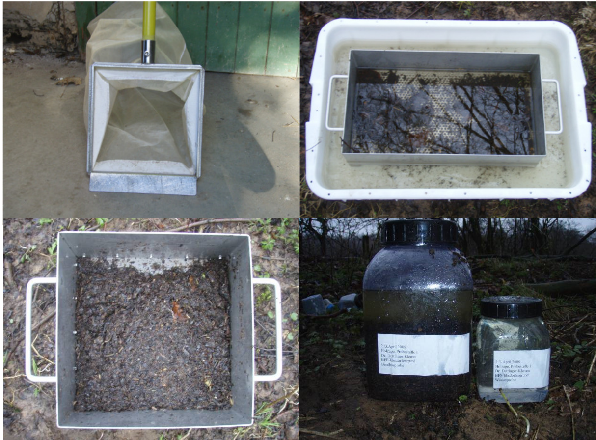
Abbildung 4: Probenaufarbeitung im Gelände: Benthoskescher (oben links), Abtrennen der organischen Grobfraction mittels 0,5 cm-Sieb (oben rechts), Rückhalten der organischen Feinfraction mittels 500 µm-Sieb (unten links), Aufbewahrung der Benthosprobe in PE-Weithalsbehältern (unten rechts).
