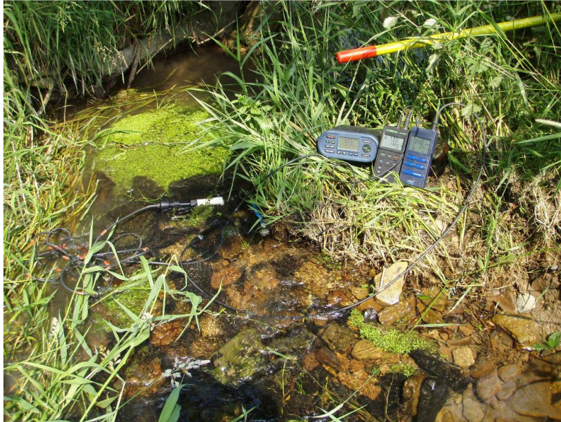
Abbildung 3: Messung der physikochemischen Grundparameter unmittelbar im Gelände mittels WTW Geländemessgeräten.
