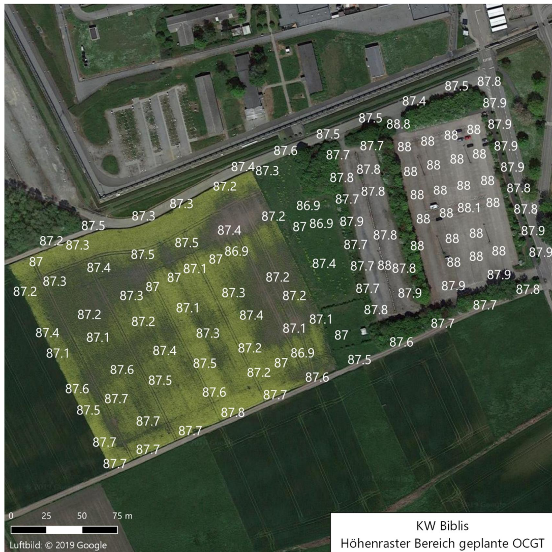
Abbildung 4-1 Geländehöhen im Bereich der geplanten Gasturbinenanlage
