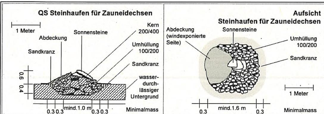
**Bauelementbeschreibung:** Strukturierter Steinhaufen mit grossen Steinen bzw. Hohlräumen im Inneren und kleineren Steinen rundum. (Kombination mit Wurzelstrünken und dicken Ästen ist möglich.)
