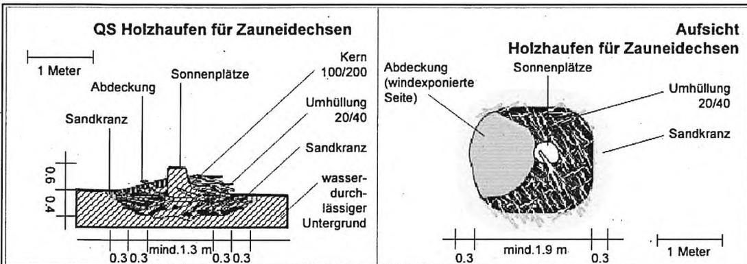
**Bauelementbeschreibung:** Strukturierter Holzhaufen mit dicken Ästen bzw. Hohlräumen im Inneren und kleineren Ästen rundherum. (Kombination mit Steinen ist möglich.)
