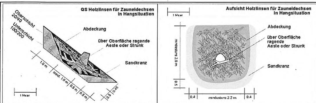
**Bauelementbeschreibung:** Flächige Holzpackung, die mit Sandkranz umgeben ist, in Hangsituation oder in Ebene. Einbau in Kombination mit kleinen und grösseren Steinen möglich.
