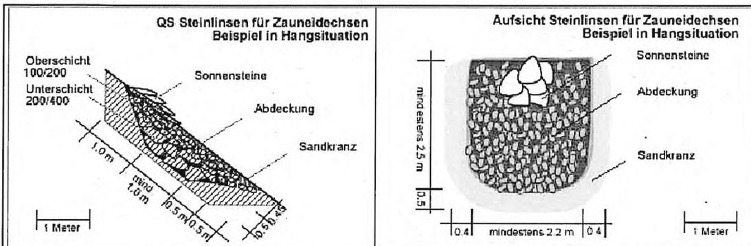
**Bauelementbeschreibung:** Flächige Steinpackung, die mit Sandkranz umgeben ist, in Hangsituation oder in Ebene. Einbau in Kombination mit Wurzelstrünken und dicken Ästen möglich.
