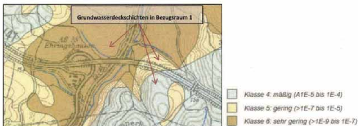
Abbildung 3: Durchlässigkeit der Grundwasserdeckschichten aus Informationssystem Grundwasserschutz Hessen (HLNUG Datenabfrage 6.3.2017)
