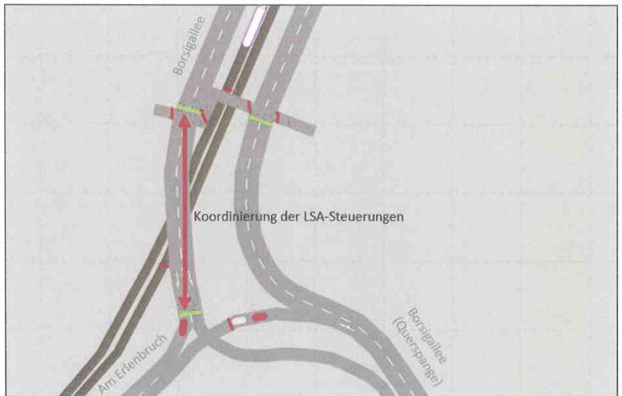
Abbildung 34: Koordination LSA Borsigallee/Am Erlenbruch/Querspange Borsigallee
