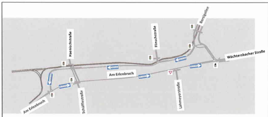
Abbildung 31: Darstellung der bauzeitlichen Verkehrsführung Am Erlenbruch
