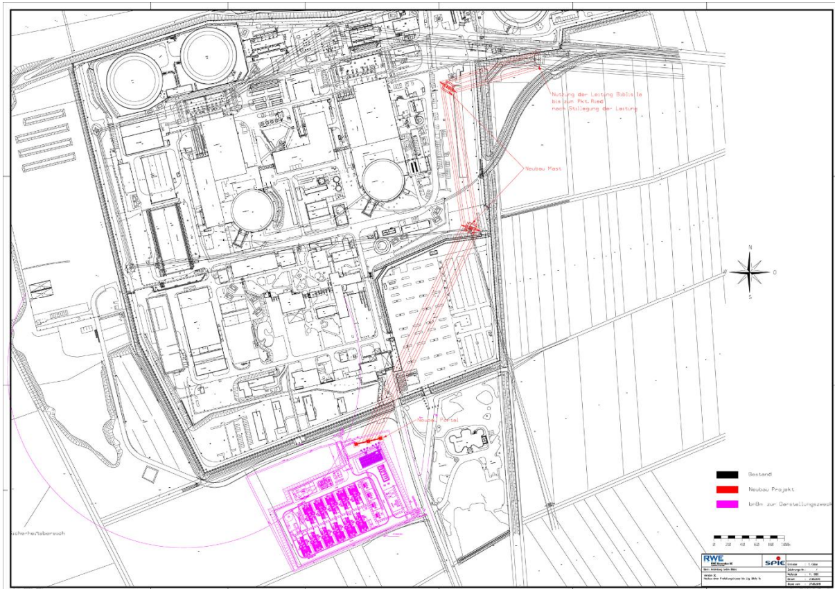
Abbildung 9: Übersicht Trassenverlauf Freileitung auf Kraftwerksgelände mit zwei Masten diagonal über Kraftwerksparkplatz
