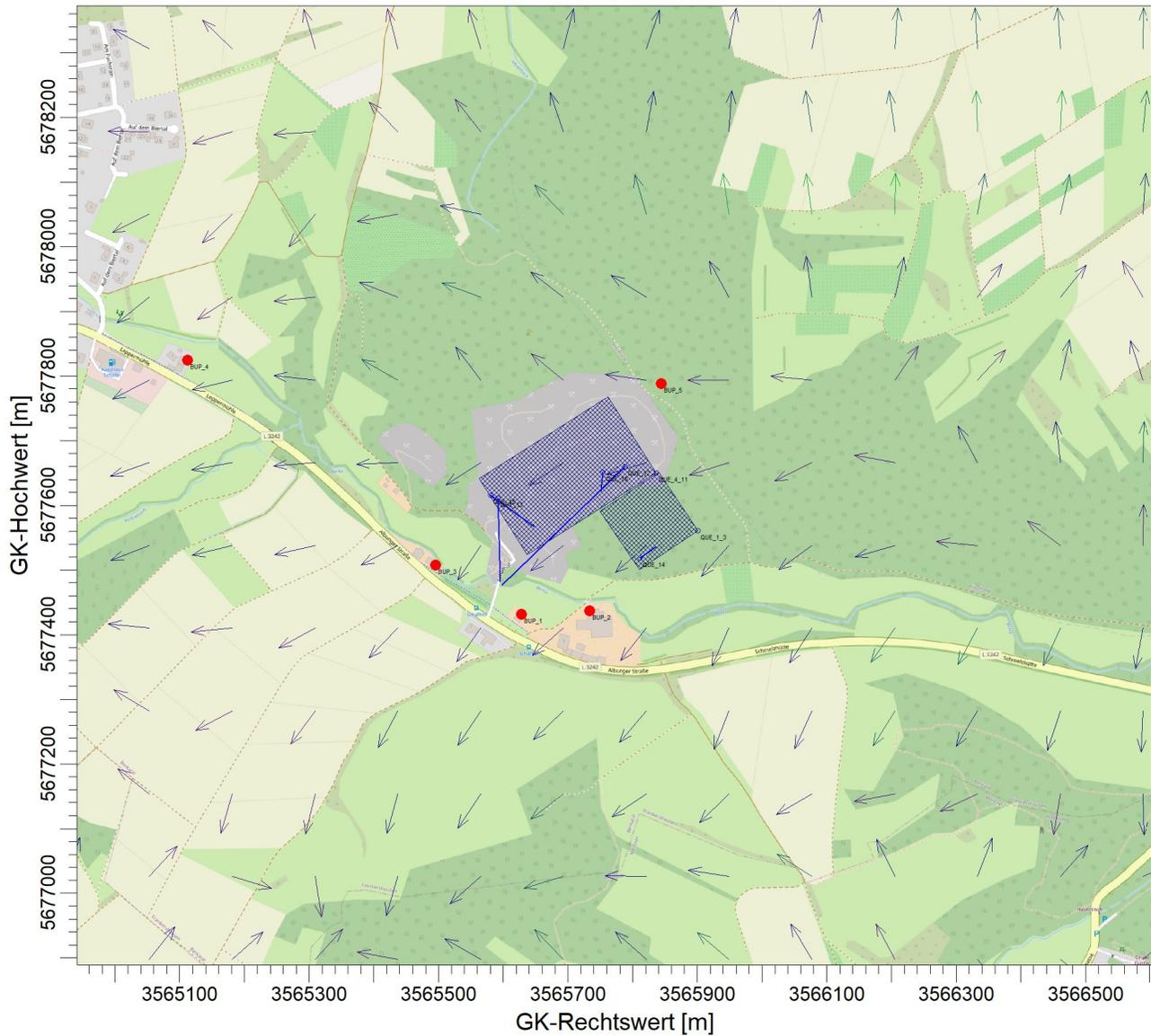
Windfeld - Ausbreitungsklasse: I, Windrichtung: 180 Grad, Schicht: 3,0 m (Uref=1,941 m/s)
