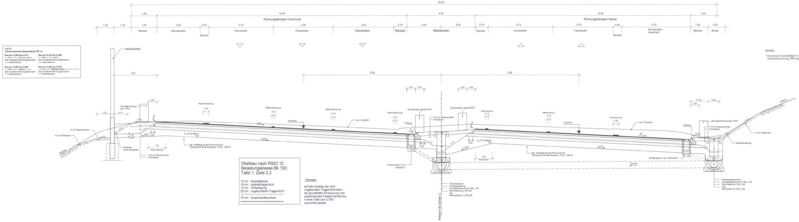
Regelquerschnitt A 45 (RQ 36, 6-streifiger Endausbau mit Einfädelsstreifen)
