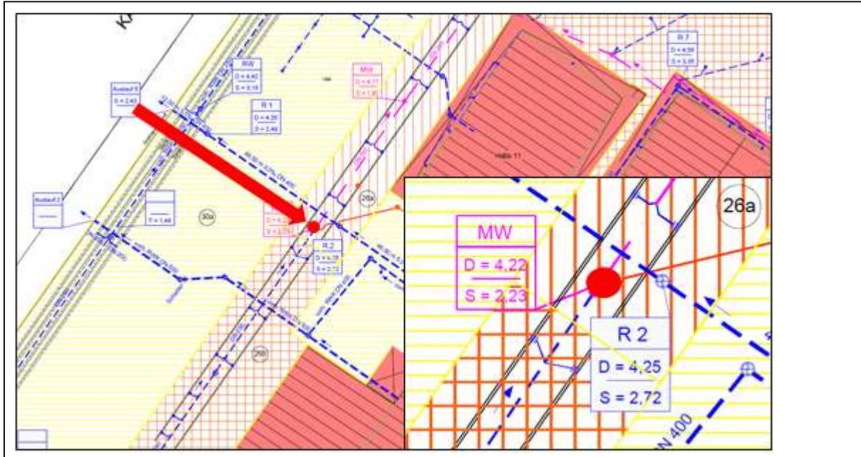
**Abbildung 7: Vorgesehener Anschluss an den Mischwasserkanal (MW)**
