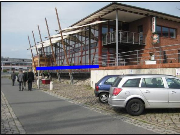
**Abbildung 3-3: Objekt Sailor's Inn mit Bemessungswasserstand (blaue Linie; +7,10mNN)**
