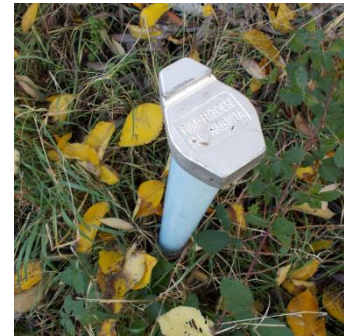
Abbildung 14: Aufschluss der Sondierbohrung am Messpegel RP2 (Grundbaulabor Bremen, 2005), Foto der Grundwasser-Messstelle (IL)
