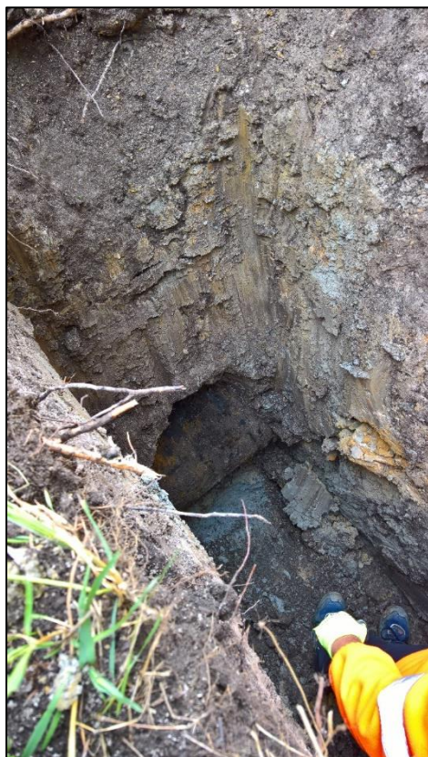
Foto 2 – Schurf 3; anstehender Boden (Ton/Tonstein); Rohrscheitel bei 1,50 m u. GOK
