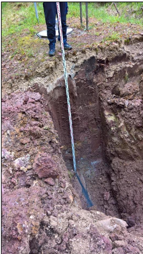
Foto 4 – Schurf 2 (Bereich KRB11); anstehender Boden (Ton/Tonstein); Rohrscheitel bei 3,0 m u. GOK
