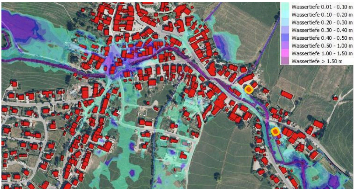
Überschwemmungen HQ100-Ist Ortskern Neukirchen
