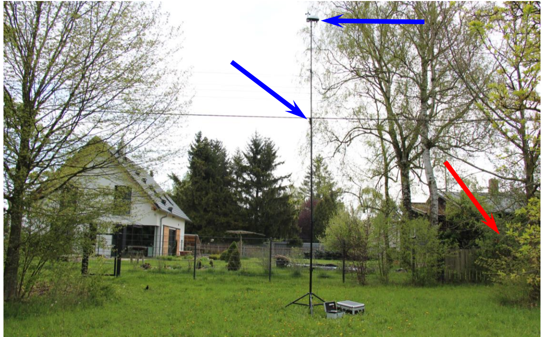
Foto 17: Blick in Richtung Osten auf das Wohngebäude IO 4 „Storchenweg 22“ (roter Pfeil), das sich im B-Plan-Gebiet Nr. 1871 „Hackersiedlung“ in einem „Reinen Wohngebiet“ befindet. Der Standort des Messmikrofons in h = 4 m Höhe über Gelände ebenso gekennzeichnet (unterer blauer Pfeil) wie der Standort der Wettermessstation der Fa. Davis am oberen Ende des Stativs.
