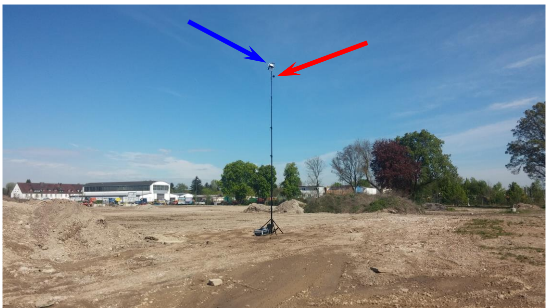
Foto 14: Blick in Richtung Norden auf den Immissionsmesspunkt IO 2c (roter Pfeil) in der Mitte der östlichen Grenze des B-Plan-Gebietes Nr. 2103 „Diamaltgelände“ für ein „Allgemeines Wohngebiet“ in h = 7 m Höhe über Gelände. Der blaue Pfeil kennzeichnet den Standort der Wettermessstation der Fa. Davis am oberen Ende des Stativs.
