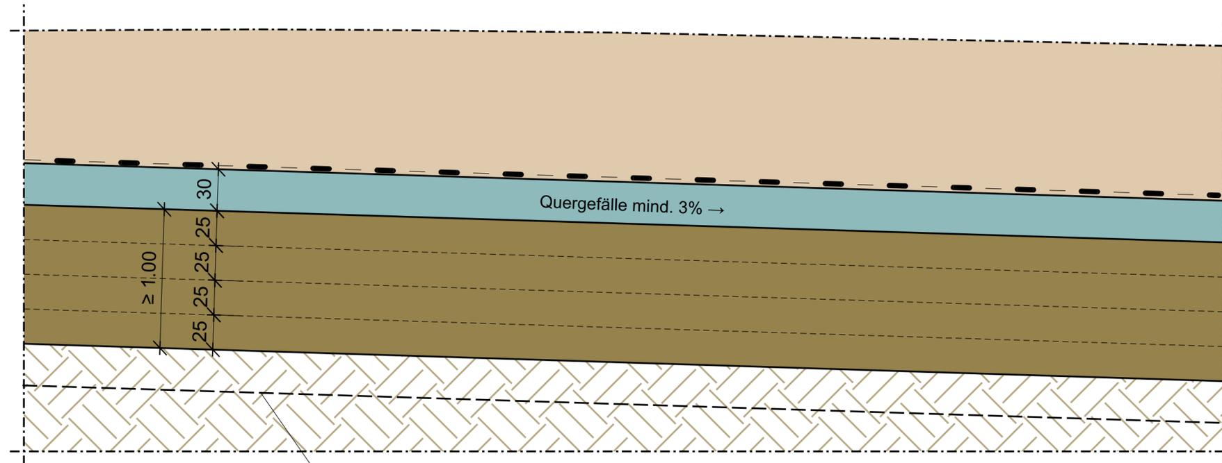
Verbesserung Deponieplanum im Bereich undurchlässiger Böden durch Kiesschicht (nach Bedarf)
