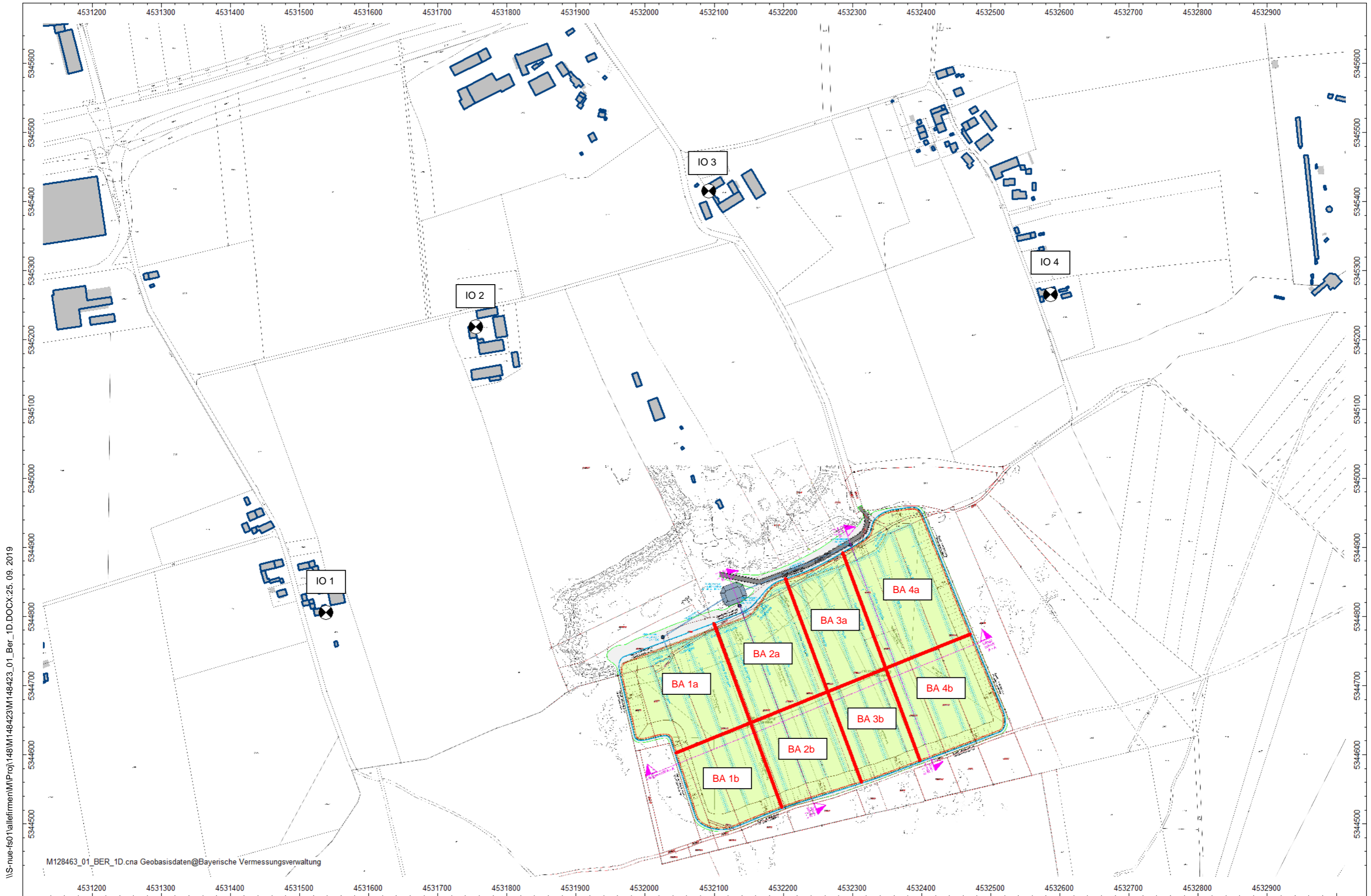
Abbildung 1. Lage der geplanten Deponie mit Kennzeichnung der einzelnen Bauabschnitte sowie der Immissionsorte. M148423/01 GRO/DNK 25. September 2019
