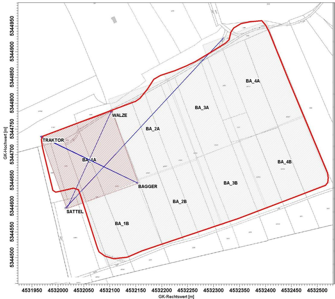
Abbildung 3. Lage der Emissionsquellen (Flächenquelle -rot; Linienquellen – blau; inaktive Quellen - grau) der geplanten DK 0-Deponie (rot umrandet), Kartenhintergrund: [24].
