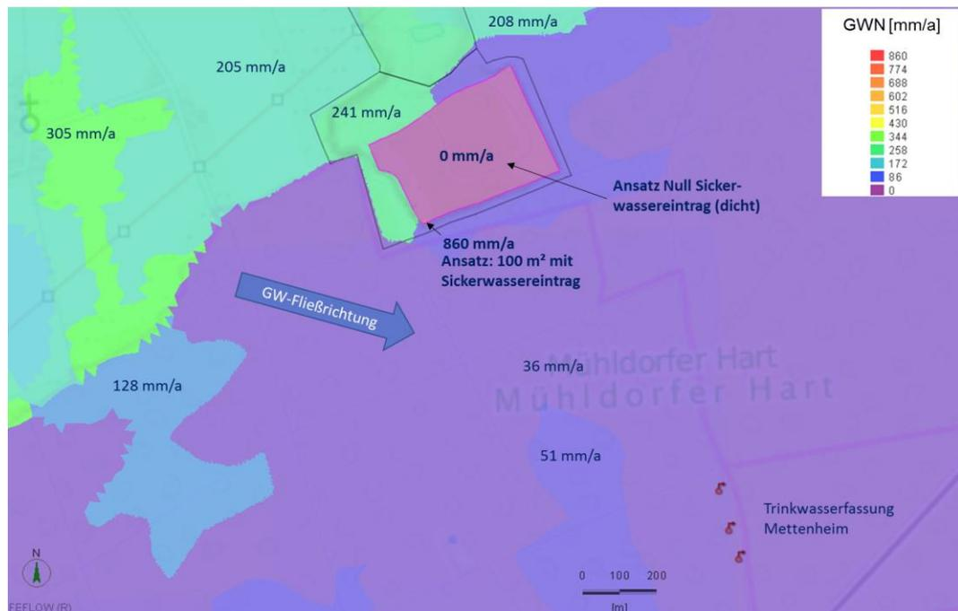
Abbildung 2-13: Darstellung der abgeleiteten Modellansätze für die Sickerwasserraten in der Deponiefläche der Grube Bäuerle sowie der Grundwasserneubildungsraten und zu erwartenden Grundwasserfließrichtung im Umfeld.
