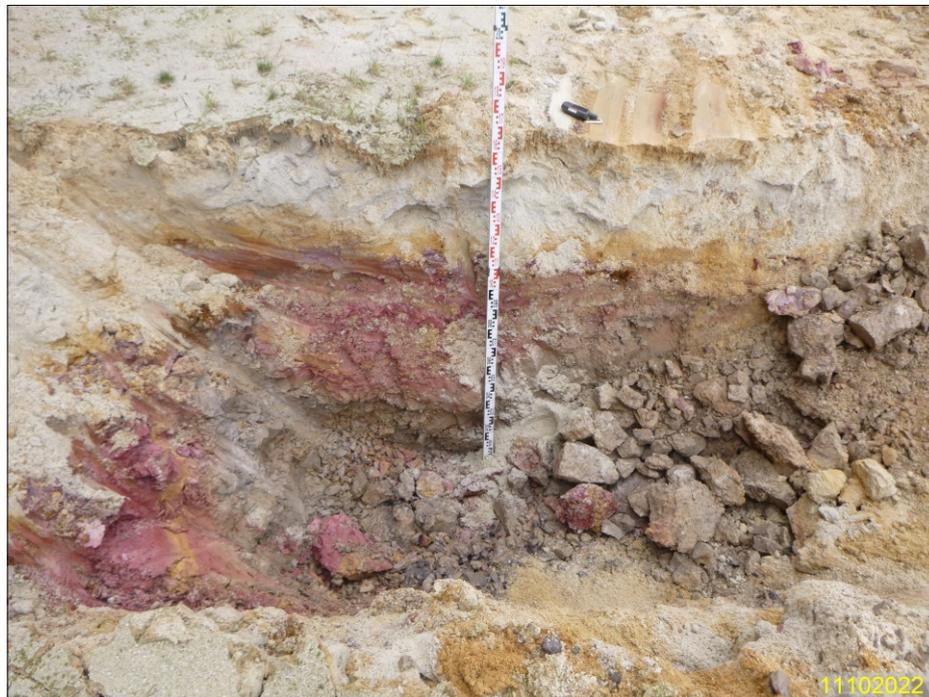
Bild 5: Aufschluss 5 (A5), Probenentnahme aus Gümbelschem Sandstein und Rhätton, entnommene Proben: A5SP1 (G. Sandstein) und A5TP1 (Rhätton)
