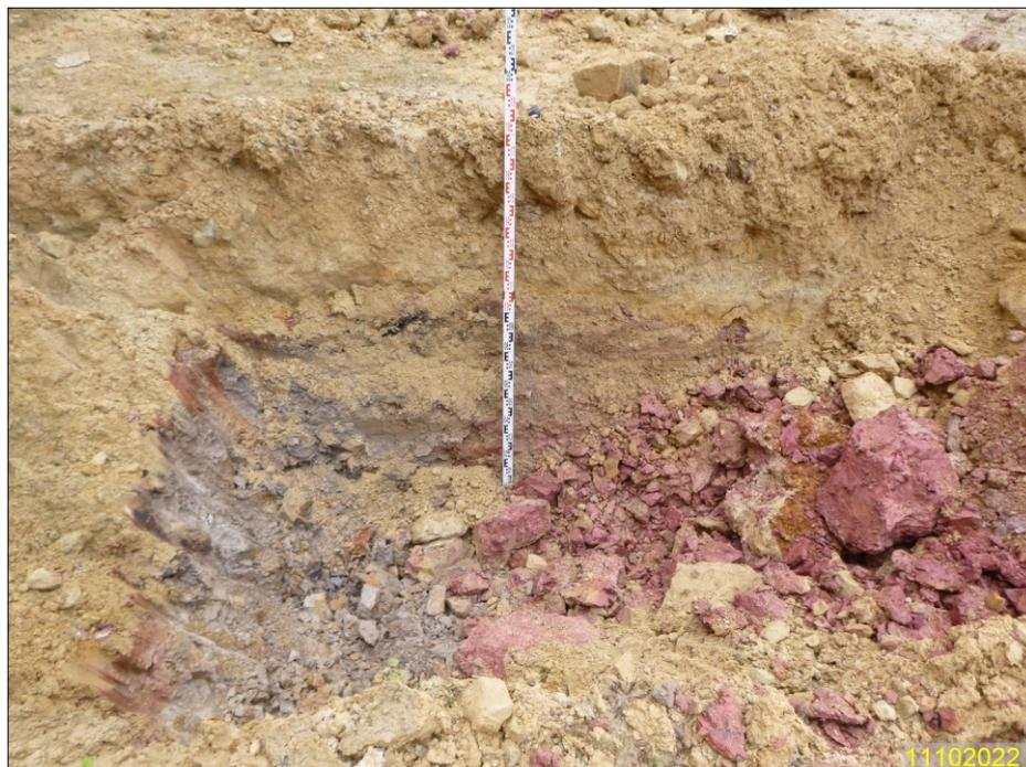
Bild 6: Aufschluss 6 (A6), Probenentnahme aus Rhätton, entnommene Probe: A6TP1
