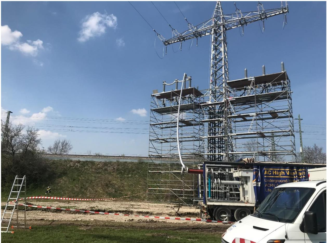
**Abbildung 24:** Hochspannungsprüfung am Mast
