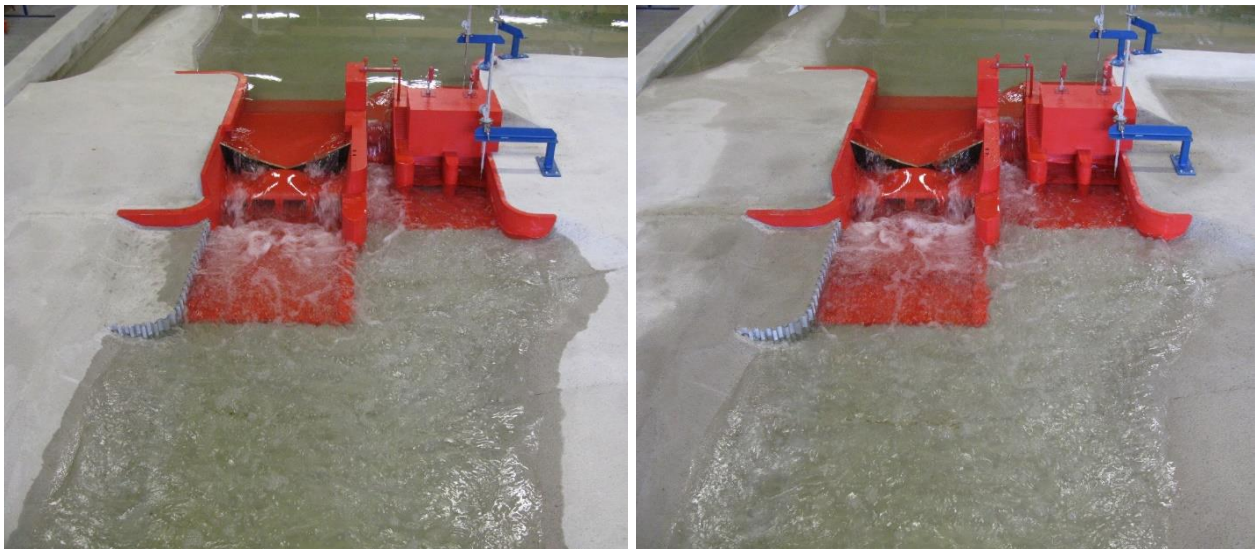
Abb. 4.11: Strömungssituation im Unterwasser im Lastfall LF1.2 ohne Störkörper (links) und mit optimierten Störkörpern (rechts) im Tosbecken der HWE I mit Blick entgegen der Fließrichtung
