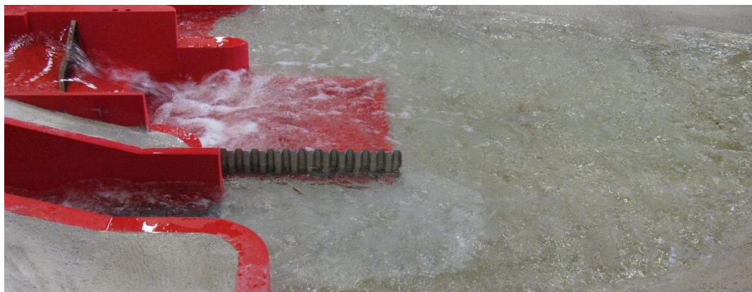
Abb. 4.18: Strömungssituation im Unterwasser im Lastfall LF2.3 ohne Störkörper (oben) und mit optimierten Störkörpern (unten) im Tosbecken der HWE IIh seitlich vom rechten Ufer
