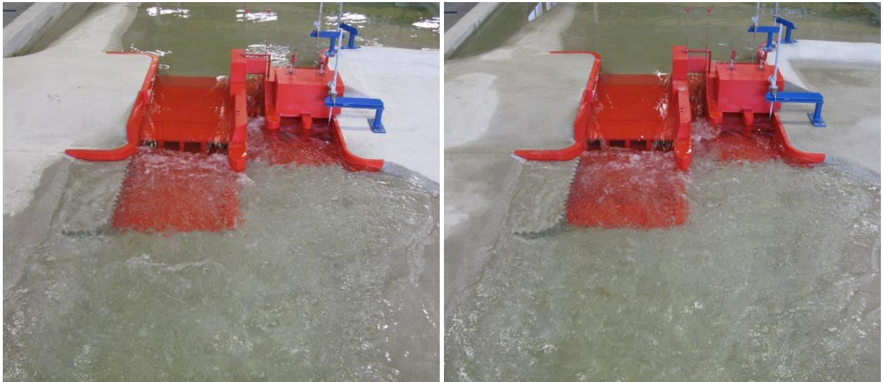
Abb. 4.9: Strömungssituation im Unterwasser im Lastfall LF1.1 ohne Störkörper (links) und mit optimierten Störkörpern (rechts) im Tosbecken der HWE I mit Blick entgegen der Fließrichtung
