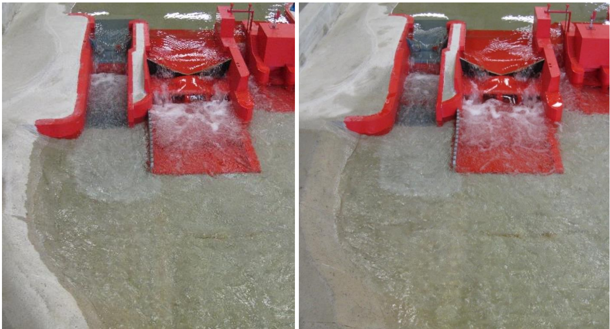
Abb. 4.17: Strömungssituation im Unterwasser im Lastfall LF2.3 ohne Störkörper (links) und mit optimierten Störkörpern (rechts) im Tosbecken der HWE IIh mit Blick entgegen der Fließrichtung
