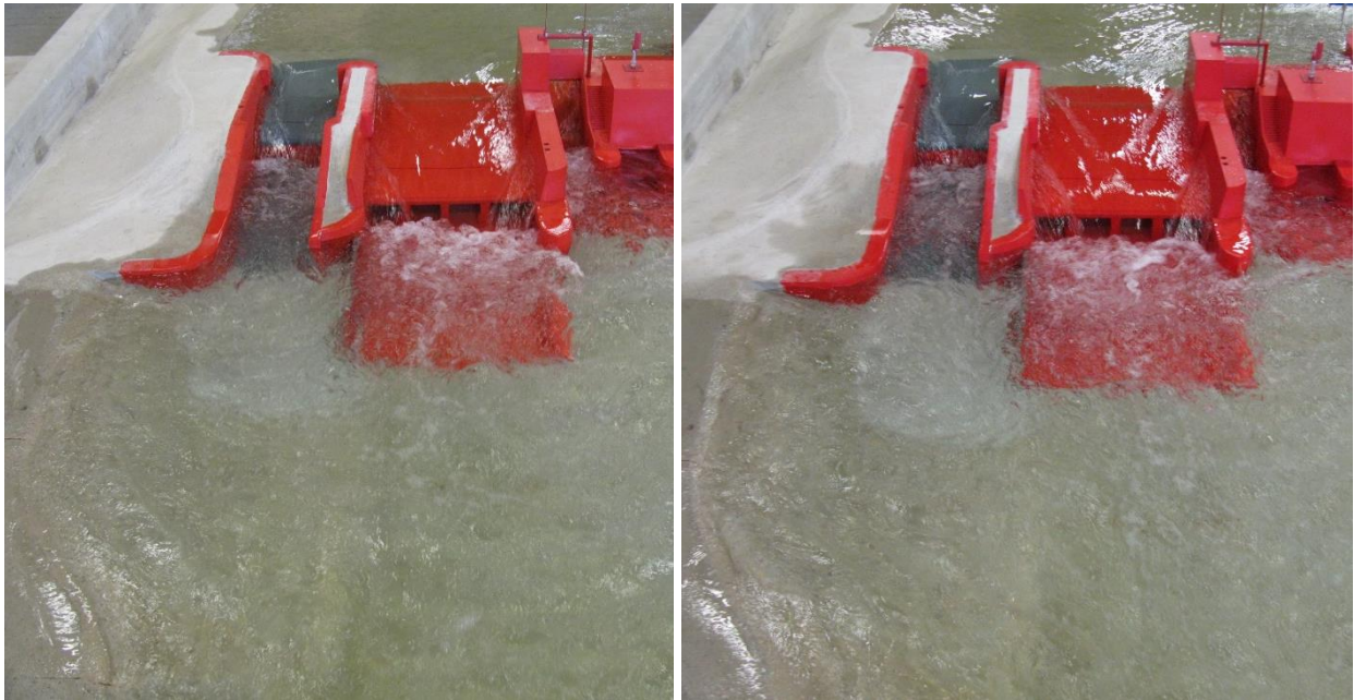
Abb. 4.15: Strömungssituation im Unterwasser im Lastfall LF2.2 ohne Störkörper (links) und mit optimierten Störkörpern (rechts) im Tosbecken der HWE IIh mit Blick entgegen der Fließrichtung
