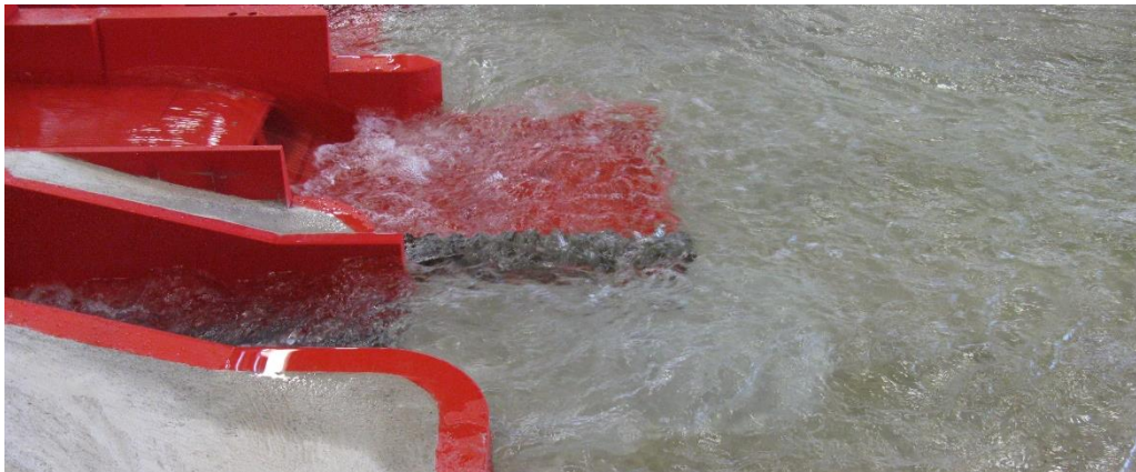
Abb. 4.13: Strömungssituation im Unterwasser im Lastfall LF2.1 ohne Störkörper (links) und mit optimierten Störkörpern (rechts) im Tosbecken der HWE IIh mit Blick entgegen der Fließrichtung
