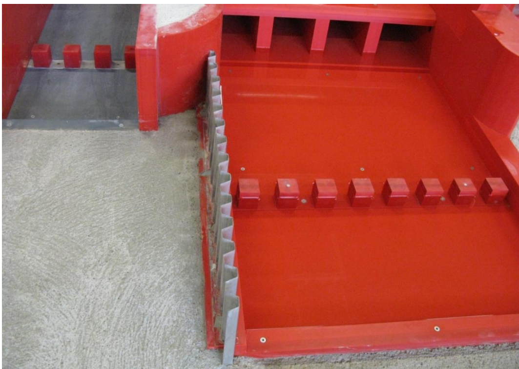
Abb. 4.8: Optimierte Störkörperreihen in den Tosbecken von HWE I und HWE IIh
