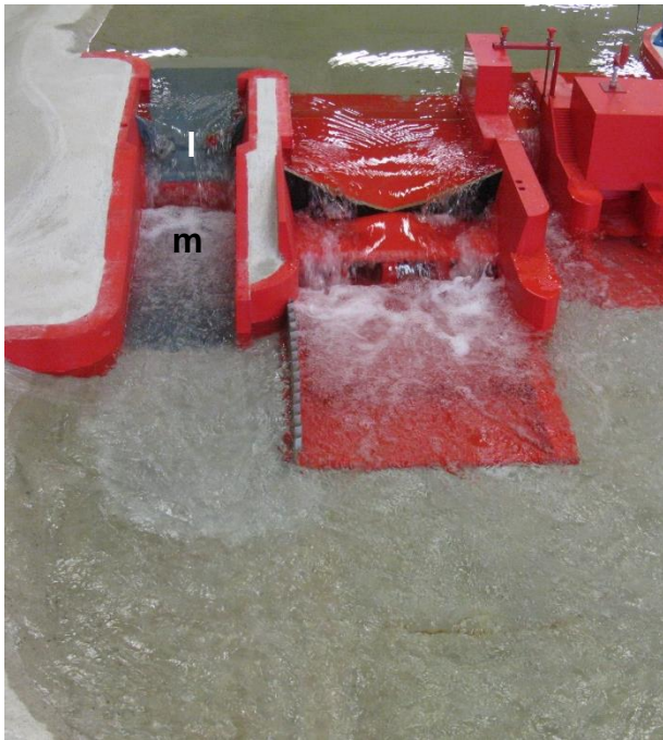
Abb. 4.6: Strömungssituation im Unterwasser im Lastfall LF2.3 ohne Störkörper im Tosbecken der HWE IIh mit Blick entgegen der Fließrichtung
