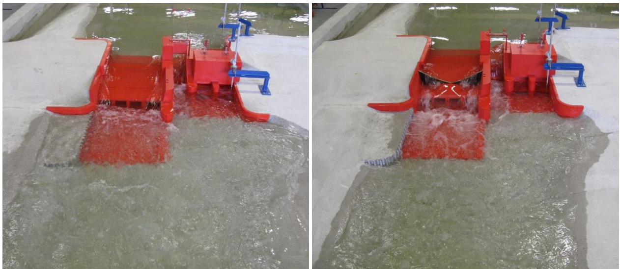
Abb. 4.2: Strömungssituation im Unterwasser in den Lastfällen LF1.1 (links) und LF1.2 (rechts) ohne Störkörper mit Blick entgegen der Fließrichtung
