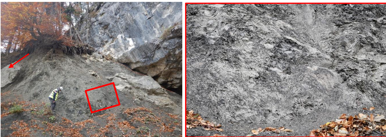
Abb. 7: Partnachsichten südlich des alten Steinbruchteils. Links: Im Kontakt zu einer Steilwand aus Wettersteinkalk. Roter Pfeil: Scherkörper aus kompetenterem Gestein. Rechts: Detailausschnitt, siehe Kasten links.
