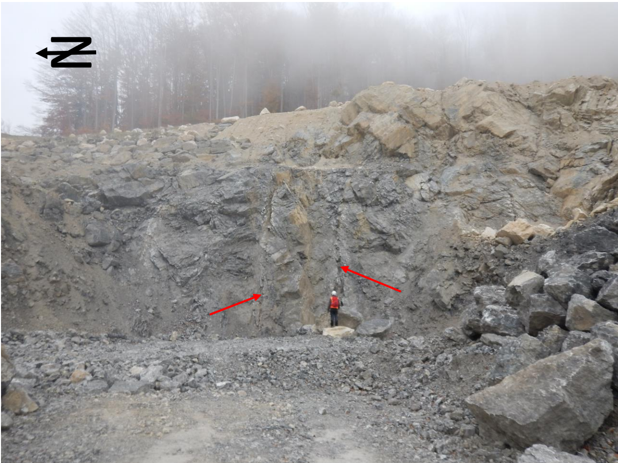
Abb. 11: Zwei parallele Großklüfte (rote Pfeile) durchtrennen den stark verfalteten Alpinen Muschelkalk.
