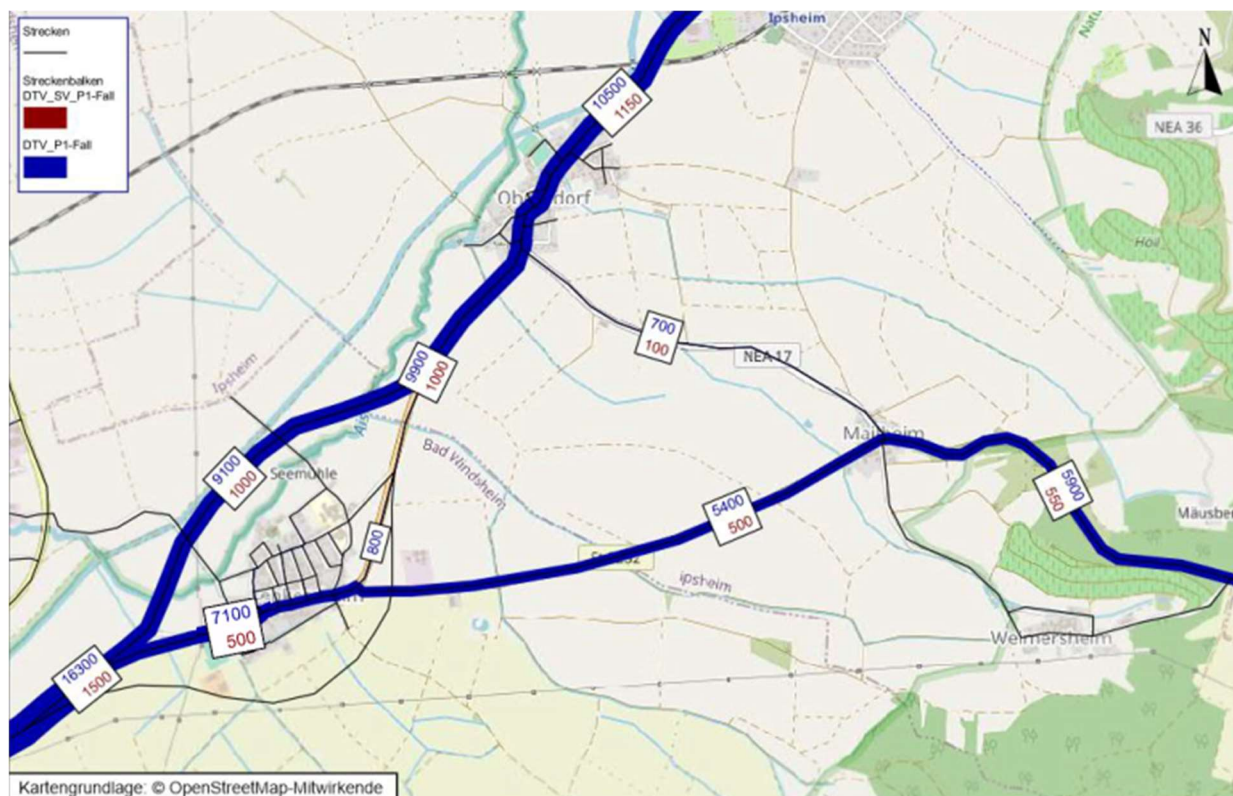
Abb. 10 Verkehrsbelastung (DTV) im Planfall 2035 (Variante Nord) Auszug aus dem Verkehrsgutachten der Brilon Bondzio Weiser GmbH, Juni 2022 (Abbildung 7)
