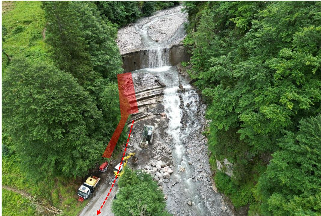
Abbildung 3: Geplante Lage der Wasserentnahme im Bereich der Sperrbachtalsperre (ITS Scheiber ZT GmbH, 2023)
